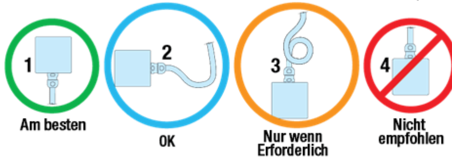
Abbildung 5.1: Empfohlene Verlegung der ServoWeld-Verkabelung.
