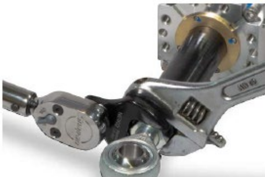
图 4.3：将附件、联动机构或载荷连接到电动缸时，在推杆末端的扁平面用扳手将推杆保持禁止状态。此处使用两把扳手：银色的扳手可以防止推力杆旋转，而蓝色的扳手会把球形鱼眼接头或其它连接选件固定在电动缸推力杆端。
