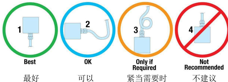
图 5.1: 推荐的 ServoWeld 布线路由。
