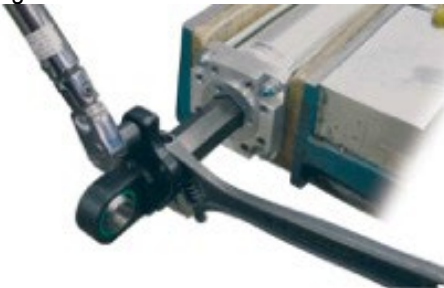
Figura 4.4: En el caso de la varilla hexagonal, mantenga fija la varilla de empuje utilizando una llave en la parte plana de la varilla cuando fije los accesorios, los enlaces o la carga al actuador. Utilice una llave dinamo-métrica para apretar el extremo de la varilla de interconexión al punto de conexión roscado del actuador. Valores de par de apriete indicados en la Tabla 4.1
